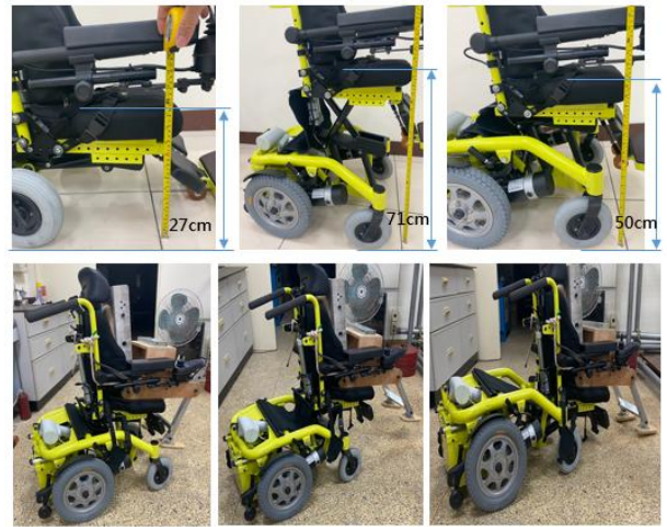
▲椅面電動升降功能測試
